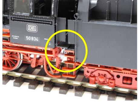
Zum Kuppeln von Lok und Tender fassen Sie die Lok am Umlauf kurz vor dem Führerhaus und drücken Sie den Tender gegen die Lok, bis Sie ein deutlichen Klicken hören.
