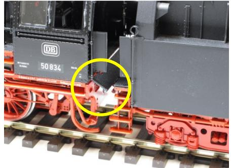
Heben Sie das Blech ggf. an und schieben Sie dann den Tender an die Lok heran.
